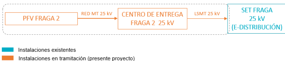
Ilustración 4: Infraestructuras de evacuación
